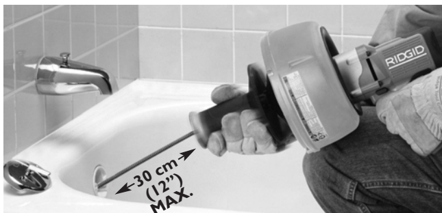
Obrázok č. 8 – Presunutie rukoväte k bubnu a zaistenie kábla v puzdre
