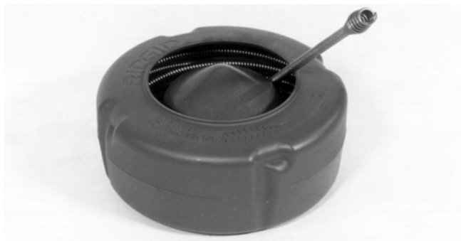
Obrázok č. 16 – Pri navíjaní káblu do vnútorného bubna kábel zvinujte V SMERE HODINOVÝCH RUČIČIEK
