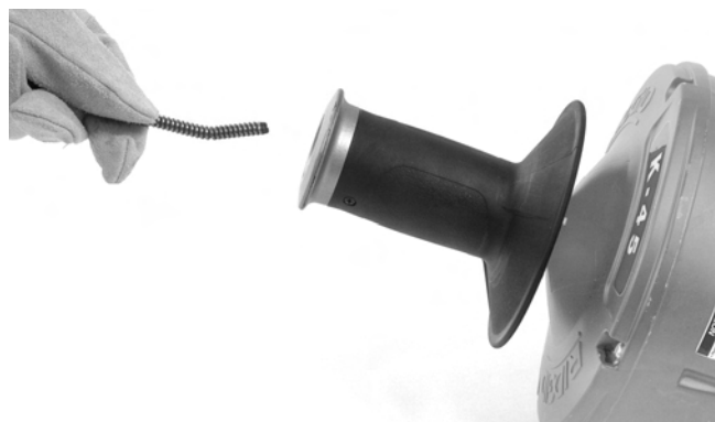
Obrázok č. 17 – Zavedenie káblu bez výmeny vnútorného bubna
