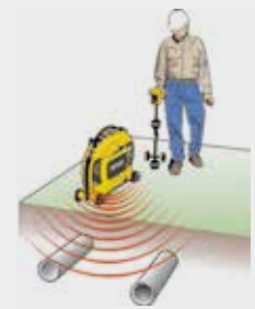
Indukcia signálu vyhľadávacím zariadením.
