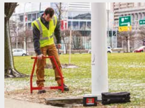
Štandardná výbava: FR-30 A-rámový prijímač, FT-103 Vysielač, Zemiaci kolk, Červené a čierna testovacie, vodiče, Prenosné púzdra, Batérie, Návod k obsluhu.
