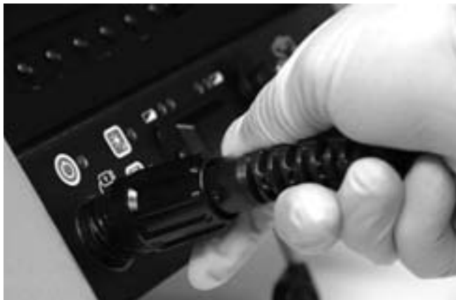
Obrázok 13 – Pripojenie sa na CCU jednotku SeeSnake
