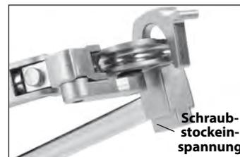
Abbildung 2 – Schraubstockeinspannung
