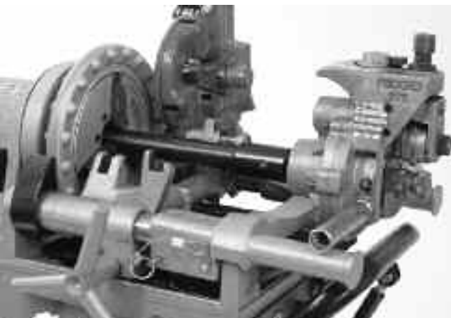
Obrázok 6 – Kombinovaný valcový drážkovač 975 správne namontovaný na Kompaktný závitorezný stroj 300
