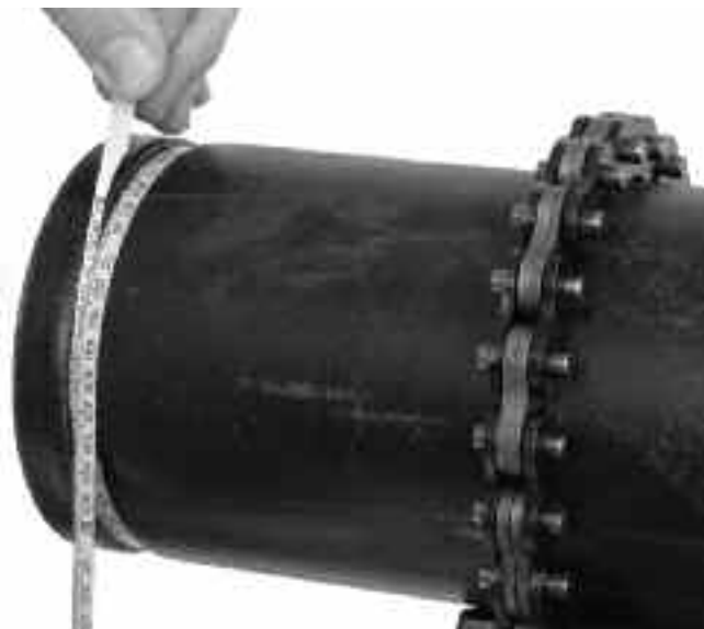
Obrázek 11 – Měření průměru drážky pásovým metrem
