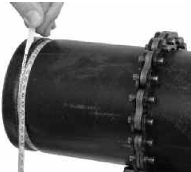
Obrázok 11 – Kontrola priemeru drážky pomocou hrúbkového pásma
