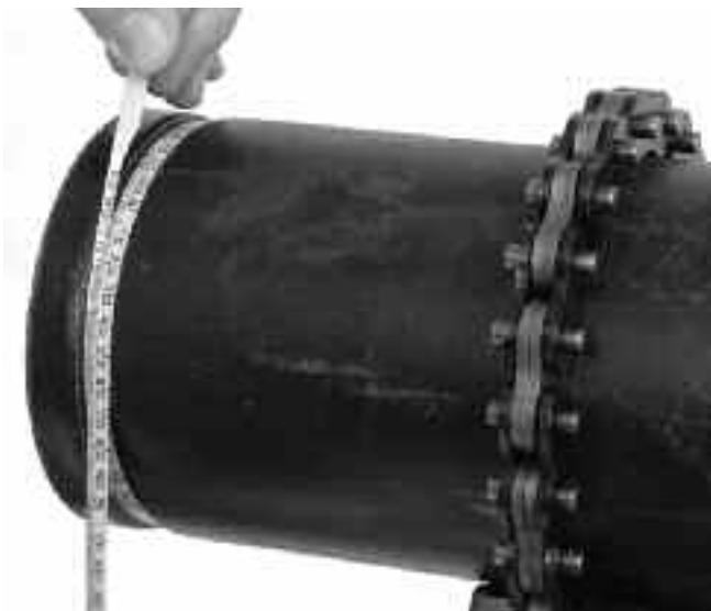
Obrázek 16 – Měření průměru drážky pásovým metrem
