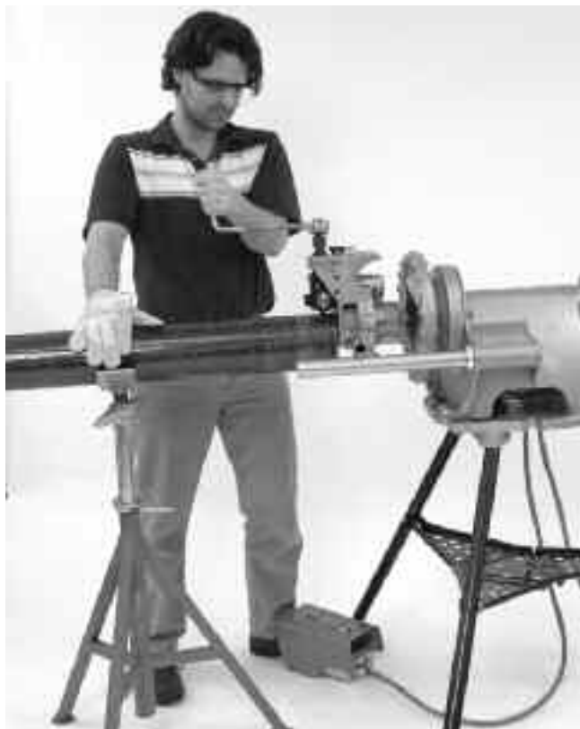
Obrázek 13 – Působení silou na trubku pro zajištění správného vedení
