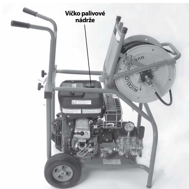
Obrázek 8 – Přístup k palivové nádrži u modelu KJ-3100
