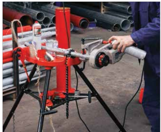
Řezání závitu na univerzálním pracovním stole s trojnožkou
