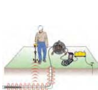
Vyhledání plastového potrubí pomocí integrovaného vyhledání vedení
